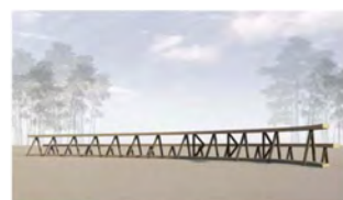
1. Stützdrillinge werden mit HEB Trägern verbunden
