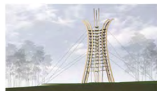
4. Aufstellen des dritten Hauptträgers mit Abspannungen
